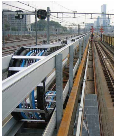
列车清洗示例：室外，风化作用 酸碱环境（洗涤剂） 行程 180 m
